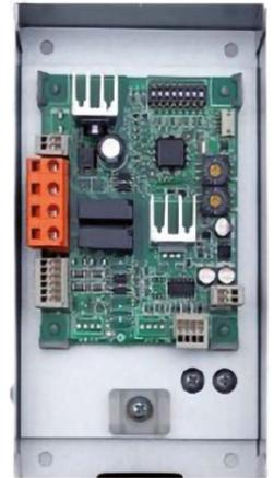
L'interfaccia è normalmente utilizzata per accumulare energia termica nel bollitore dell'acqua sanitaria in caso di surplus di produzione di energia elettrica da parte di un impianto fotovoltaico.
